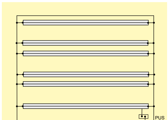
Potentialutjämning av ramverk, där man inte upprätthåller skiljeavstånd.
